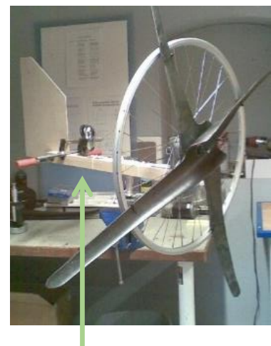
Billede 2: Bommen er det stykke, der forbinder vinger med haleror
