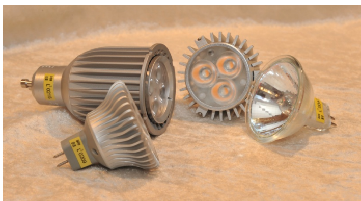
Figur 1 Typiske retningsbestemte LED produkter, samt et enkelt halogenspot som er blevet testet i projektet.
