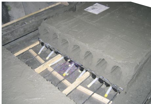
Under projektet har Spæncom udført prøvestøbninger, der viser, at de kulde- og varmetransporterende slanger godt kan indstøbes industrielt i kraft af en tilpasset sandwich støbeteknik. (Foto: Finn Passow, Spæncom)
