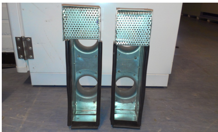
Figur 4-26: Overgang til NilAirflex slanger med klemprofil og hulplader til trykudligning.
