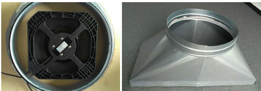
Figur 4-14 Til venstre ses ventilatoren i en Ø355-nippel og luften kastes roterende ud langs den indre periferi (ud af billedet) og fortsætter, via muffen i overgangen til højre, ind i manifolden.
