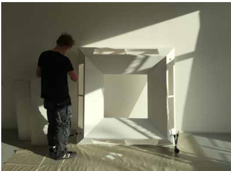
Konstruktionen af 'lysning'. Et instrument til observation af dags- og kunstlys integrering. Ved hjælp af instrumentet etableres en særlig fokus på ude-inde forholdet.
