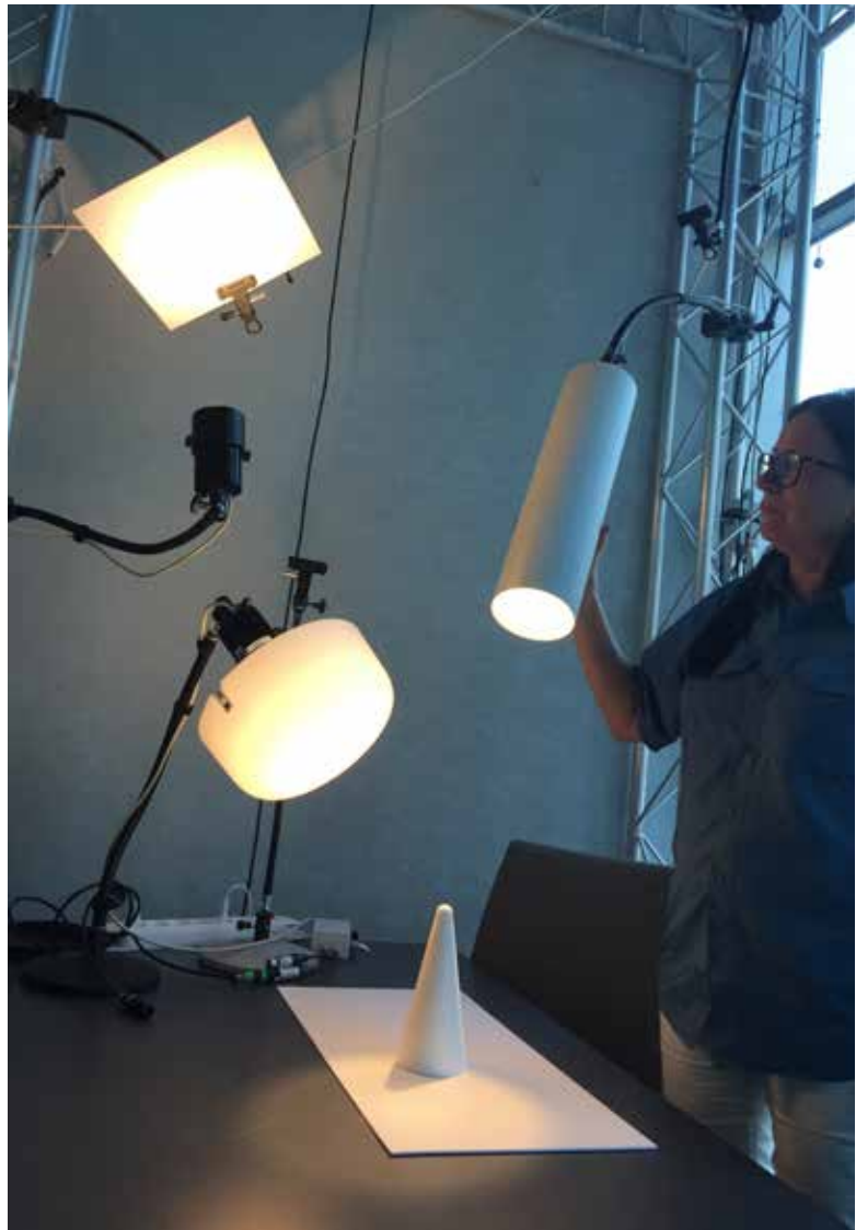
Tre former for lysgivere: rettet, diffust og reflekteret lys. De tre former for lysgivere anvendes i testopsætninger til at komponere de adaptive lysforekomster.
