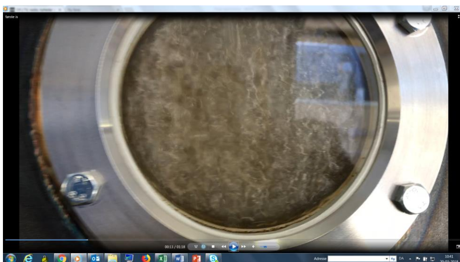
Figur 33 Første gang der blev dannet is. Figuren viser skueglas med indvendigt islag.
