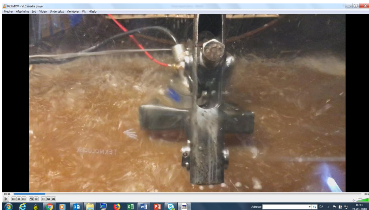
Figur 42 Omrøreren skabte den ønskede aktivitet i beholderen. Den røde tilledning er forbindelsen til tørkvælstof.
