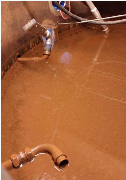
Figur 38 Dyserne kunne også montres med spredere, som gav en større overflade til frysning af iskrystaller.
