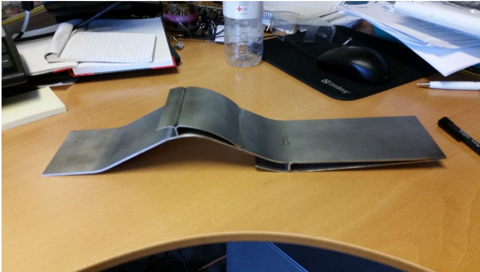
Figur 50 Et snit gennem de hule knockoutplader til dråbeseparering.
