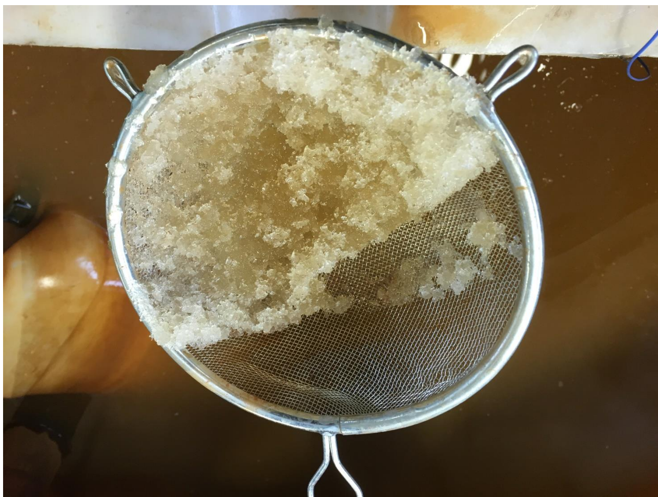
Figur 44 Der kom en del is med ud fra beholderen, inden indløbet til pumpen blev blokeret af is, der pakkede. Hentet fra lagertanken umiddelbart efter testkørslen.
