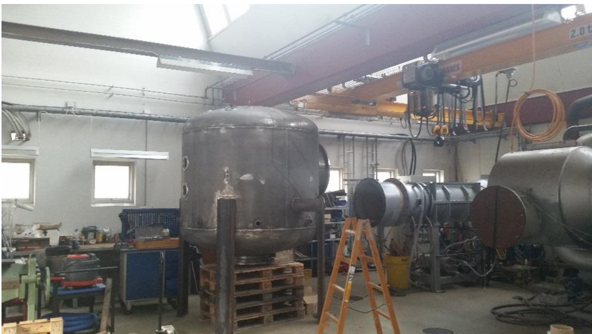
Figur 28 Fordamperen monteres direkte på den eksisterende kompressor og testrig.
