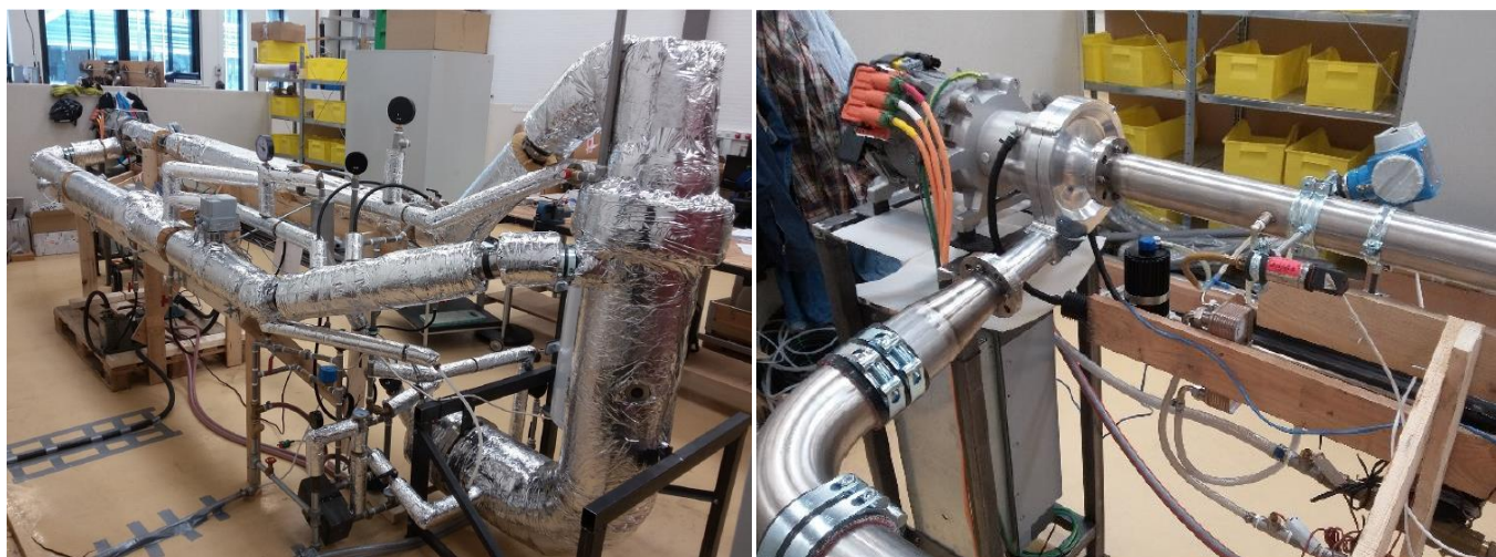
Figur 38 Testloop på DTU med nærbillede af kompressoren før isolering.
