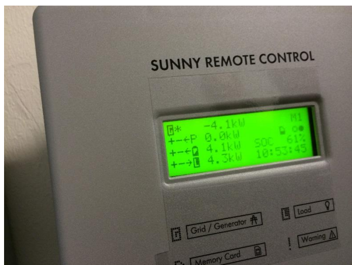
Figur 13 Sunny Island brugerpanel med de vigtigste systemdata
