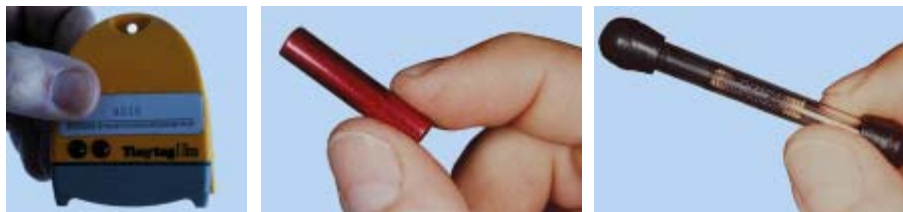
Figur 11. TinyTag Ultra , PFT sporgaskilde og PFT adsorptionsrør.
