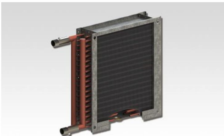
Figur 7.2 Varmeveksler med alle rør i parallel. Der er 4 slag og rørene er tilnærmet modstrøm. Hvis antallet af rørrækker forøges vil den kunne give en god tilnærmelse til modstrøm.
