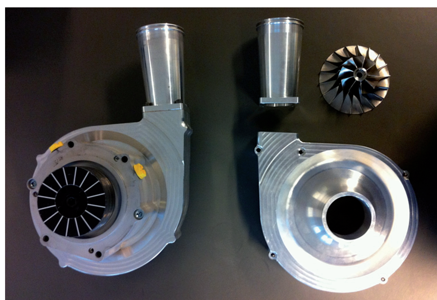
Den udviklede Rotrex kompressor for vanddamp.
