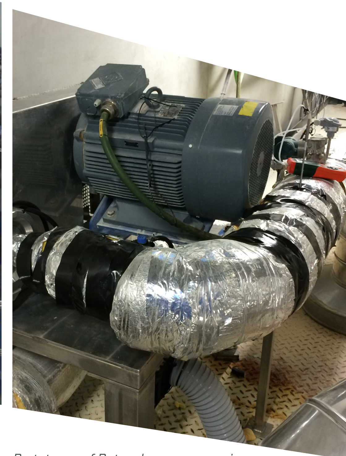
Prototypen af Rotrex kompressoren i Weel & Sandvigs demonstration hos Haldor Topsøe A/S, Frederikssund.
