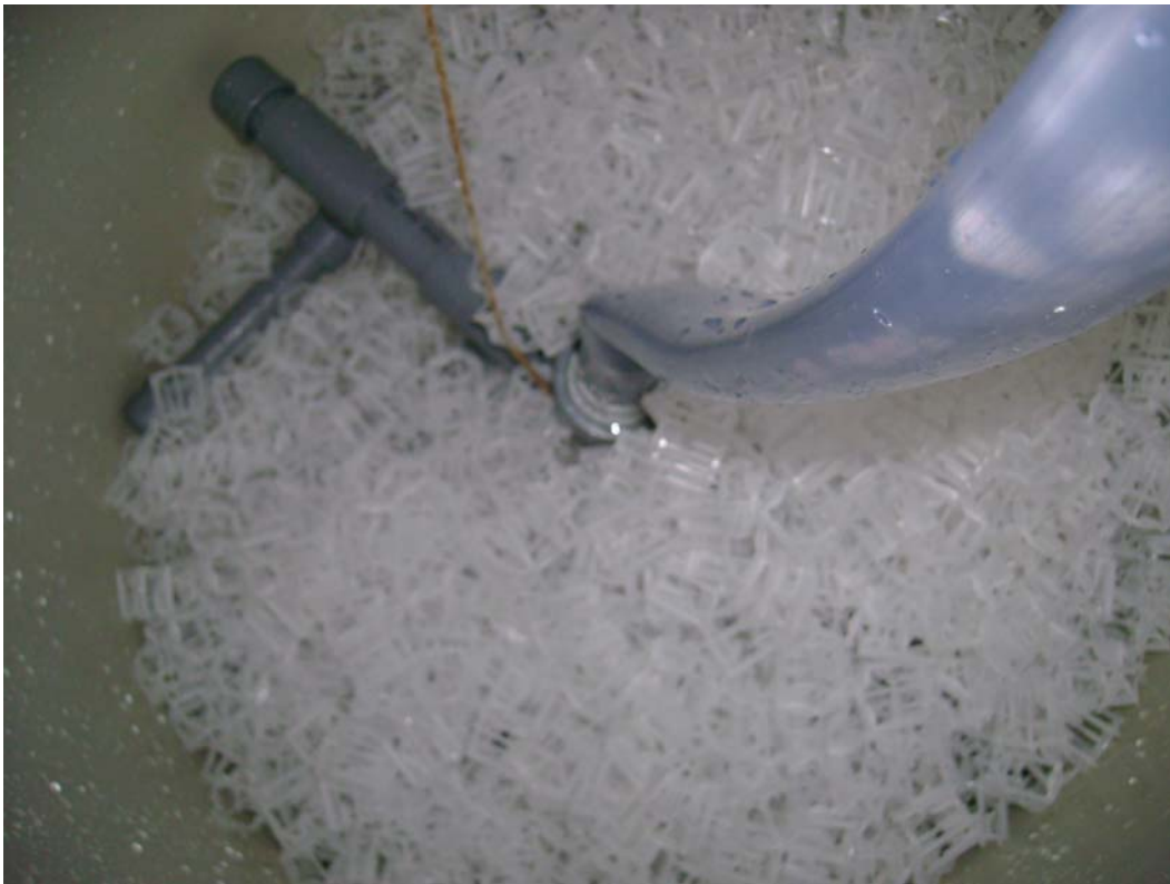
Figur G-2: Væskefordeler monteret i toppen af tårn, delvist dækket af fyldlegemer.
