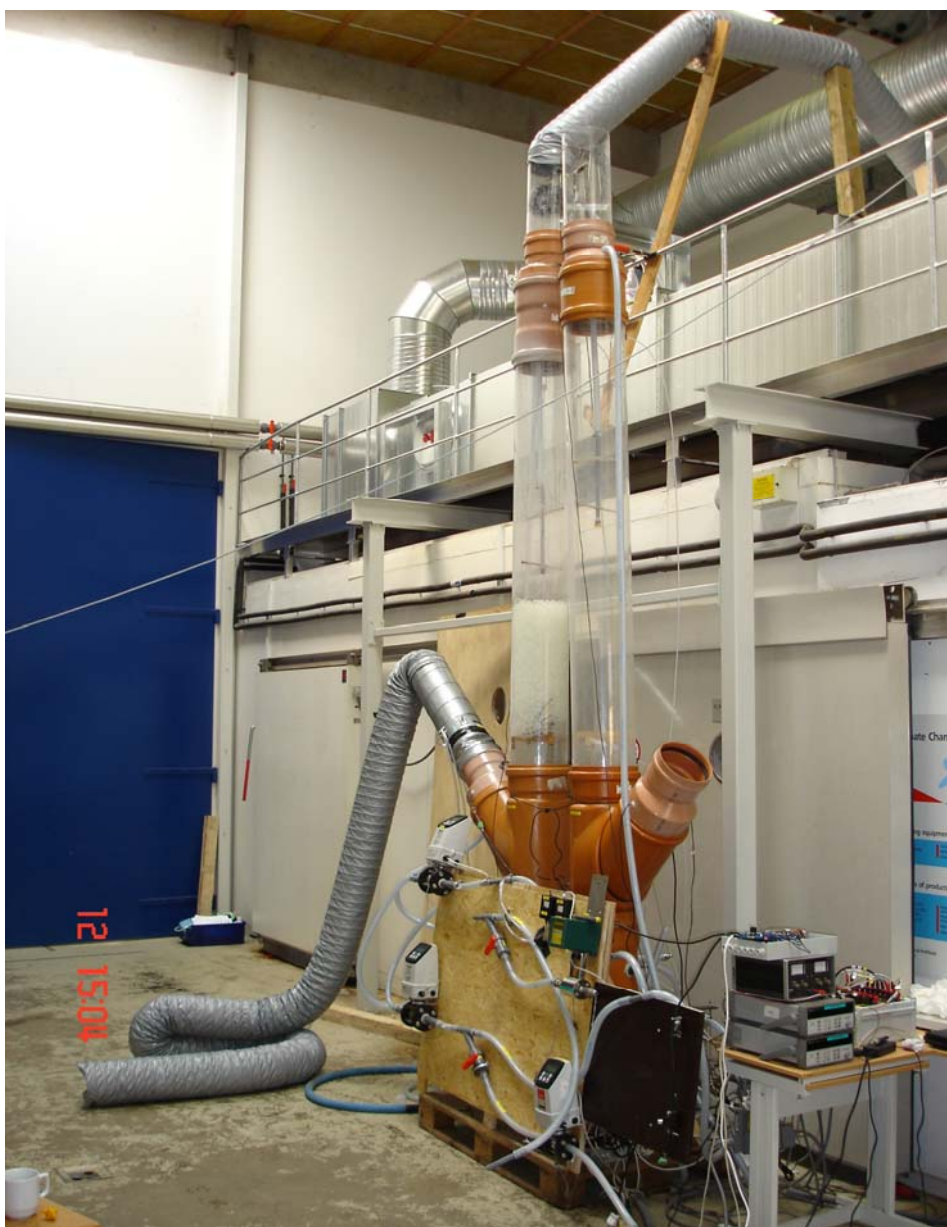
Figur 29: Andet pilotanlæg med lodretstående luftvaskertårne.
