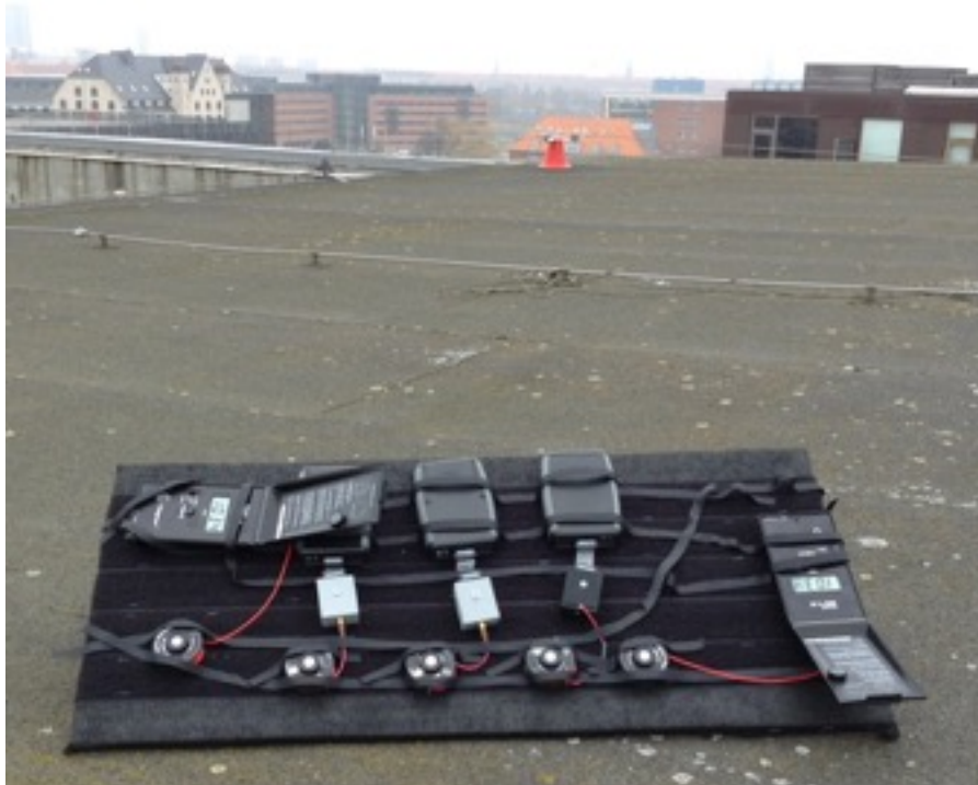
Fig. 1Xxx. Billede af opstilling til test af Sense-it systemet med Hagner lys-sensorer under dagslysforhold (under solformørkelsen d. 20. marts. 2015)
