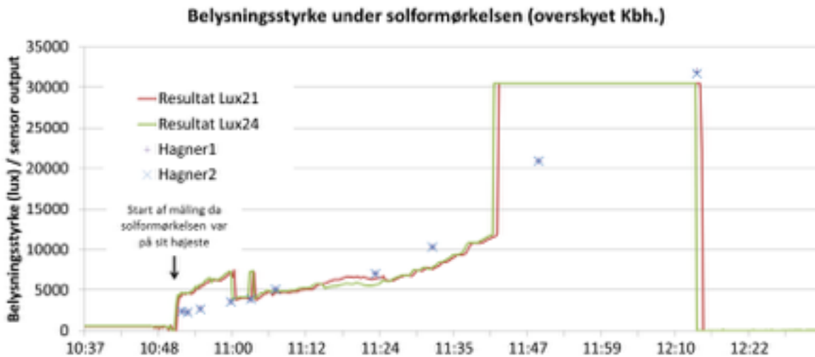
Fig. 2Xxx. Grafer visende resultat fra målingerne foretaget under solformørkelsen d. 20. marts. 2015 med Sense-it systemet med Hagner lys-sensorer. Der ses nogle tydelige spring i data som viste sig at have at gøre med funktioner til energibesparelser for optimering af batterikapaciteten i systemet. Dette blev eftervist og funktionerne fjernet.
