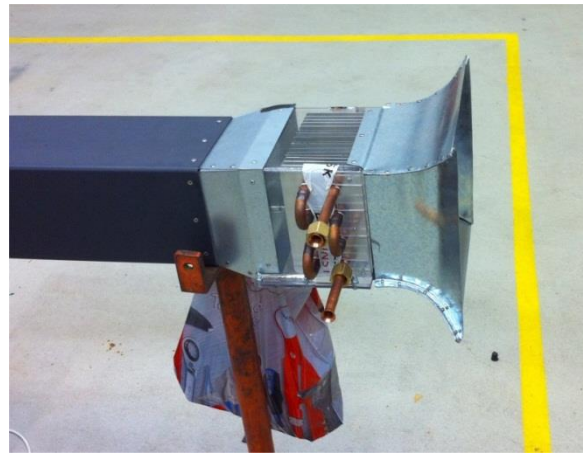
Billede 2: Afrundet indløb monteret på testopstilling.
