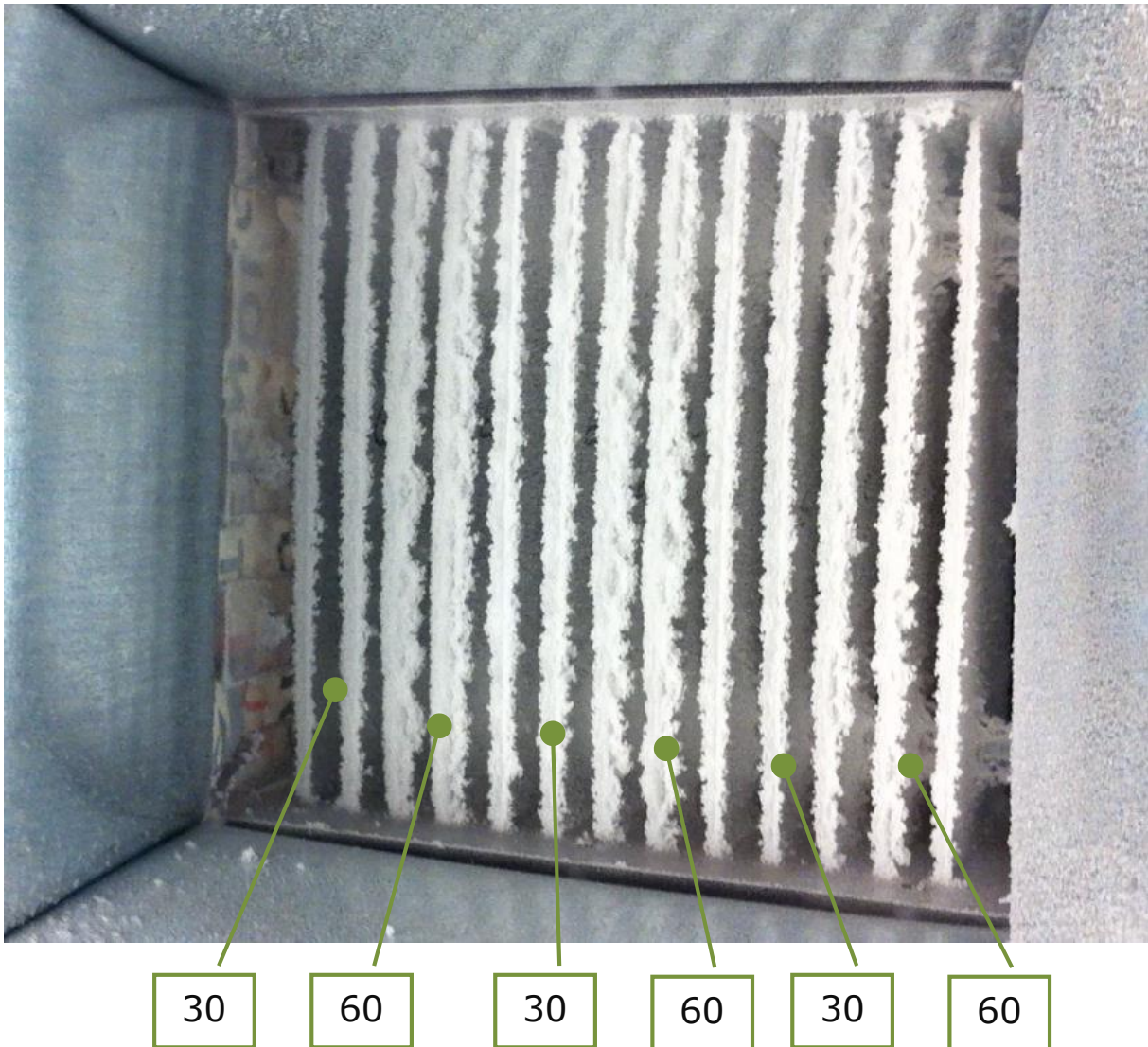
Billede 11: Vinklen på finnerne har indflydelse på opbygning af rim.
