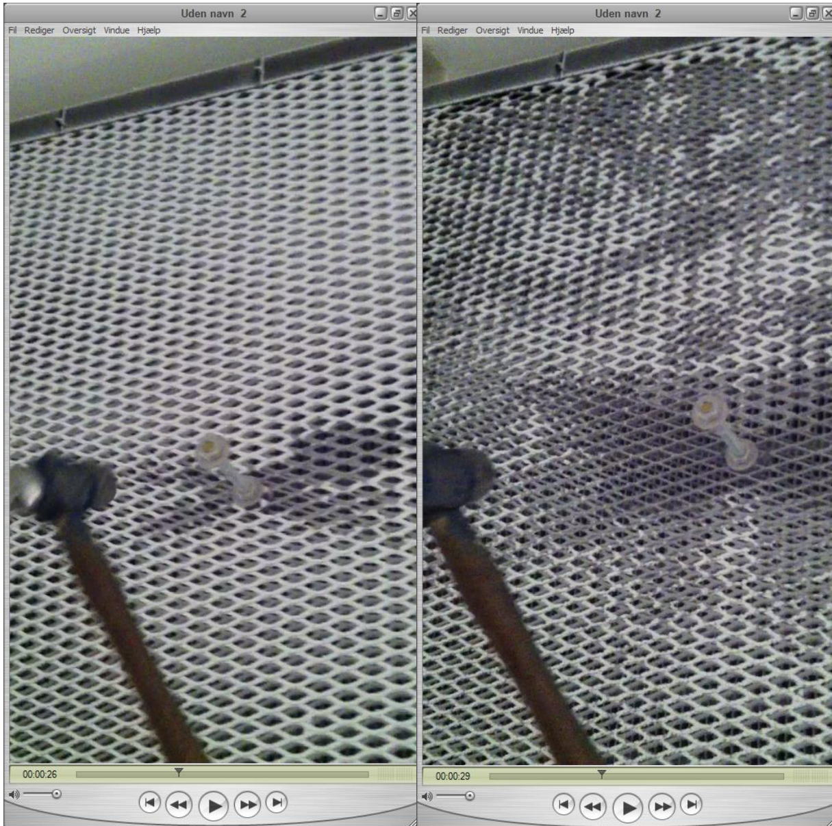
Billede 15: Gitteret før (venstre) og efter (højre) slag med en hammer.
