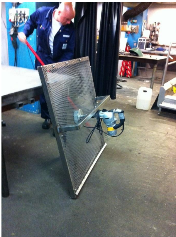
Billede 21: Borehammer monteret på gitterets ramme fungerer som vibrator til afrimning af gitter.
