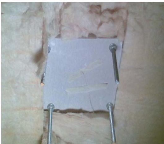
Figur 4. Laboratorieforsøg. 18 stk. 15 mm SmartBoards boltet sammen.
