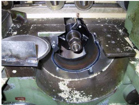
Figur 4 Princip for ny underskærm med ny indsats
