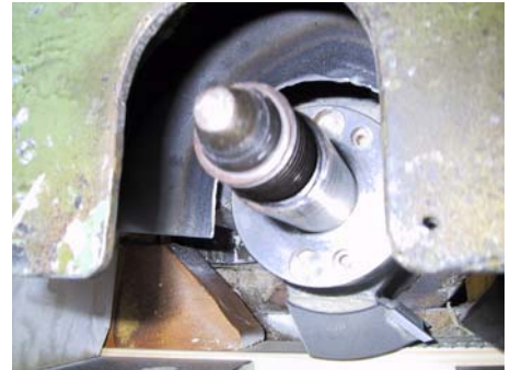
Figur 26 Ny ledeplade i sugeskærm
