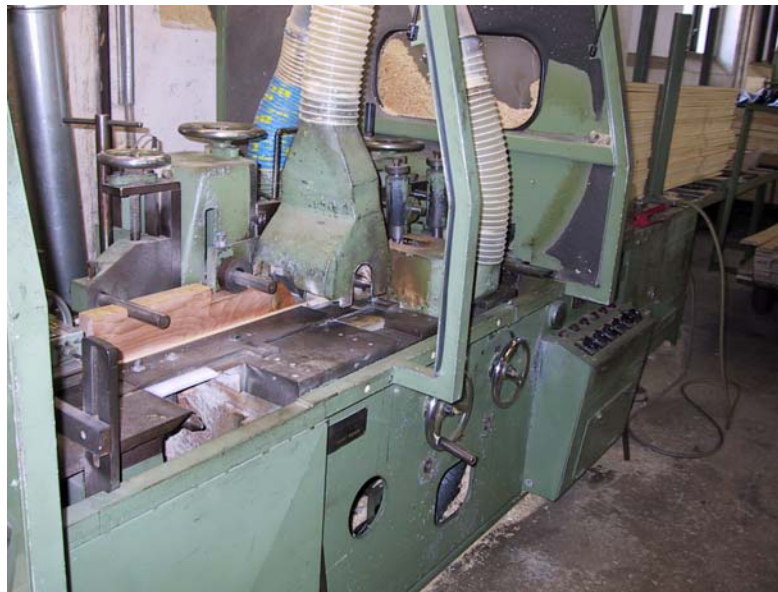
Figur 5 Foto af kehlmaskine af fabrikatet Grama med 5 spindler før montage af nye sugeskærme
