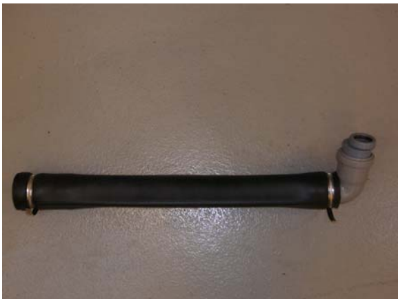
Figur 44 Rør med perforeret gummistrømpe
