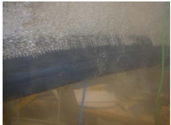
Figur 45 Rør med perforeret gummistrømpe under forsøg
