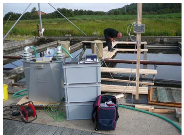
Figur 32 Bælgmåler og udstyr.
