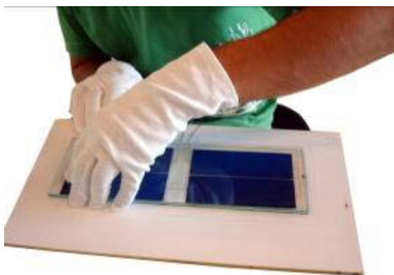
Forsøg med laminering af SunPower cellen, samt forsøg med forskellige tynde metaltråde, som lederbaner.
