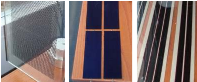
De 3 udvalgte teknologier: Japanske Kyosemi-celler, SunPower celler og RISØ's polymerceller
