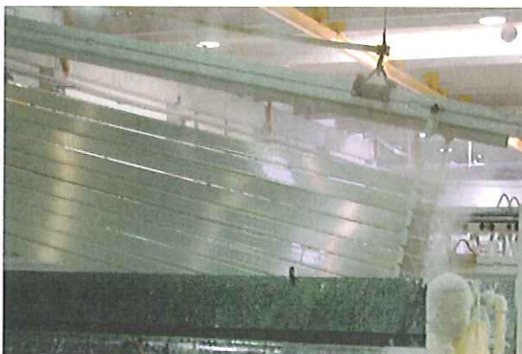
Anodisering, her af aluminiumprofiler, hos Sapa Profiler A/S.
