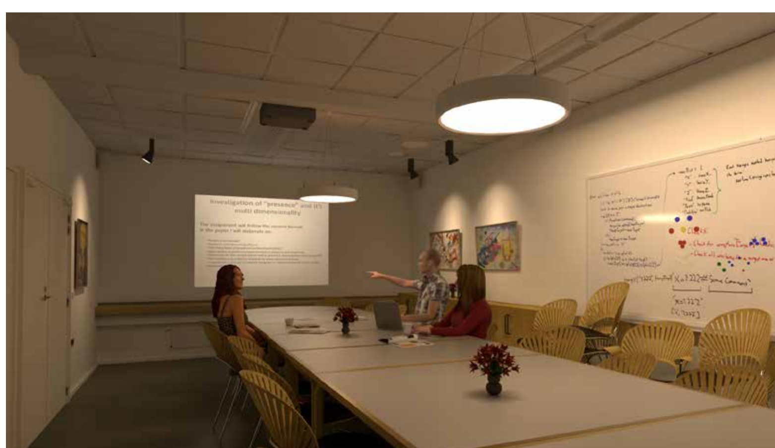
Tre visualiseringer med forskellige belysningskoncepter. Testpersonerne bedømmer en række lysscenerier, der viser forskellige belysninger af det samme rum og varierer f.eks. i forhold til antal og placering af armaturer og lysets farve og intensitet. Metoden gør det nemt og billigt at teste mange scenarier for hvert rum.
