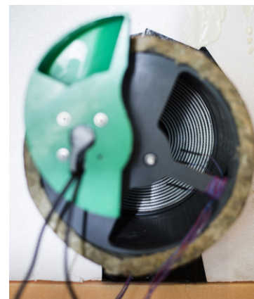
Figur 4. Spiralvarmeveksleren vist efter oprulning hos Brønnum Plast.
