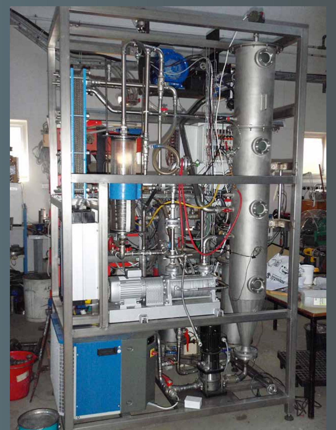
Testinddampner med Rotrexkompressor i Teknologisk Instituts laboratorie.
