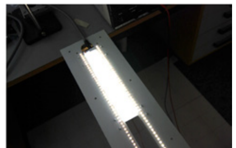
Foto af fiberlys koblet ud af lysblandingsklodsen, hvor de hvide LED'er i hybridarmaturet er tændt.
