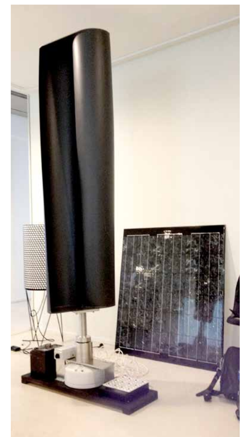
Foto af funktionsmodel til vindmølle i CopenHybrid. Turbinen er ca. 180 cm høj og ca. 50 cm i diameter. Vindmøllen er monteret på en elektrisk generator med en maksimal effekt på 500 W. Til højre for generatoren er placeret et array med LED-lyskilder, til venstre batteri (sort boks) samt SOLVEI-styringsboksen (hvid boks). Op ad væggen bag vindmøllen ses et solcellepanel. Foto: Jesper Wolff, DTU Fotonik.
