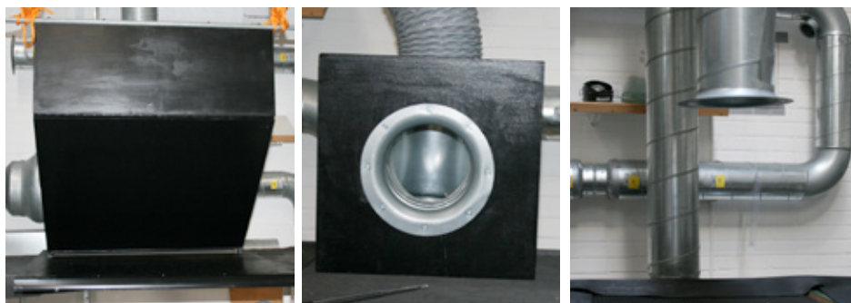
Eksempler på 3 forskellige udsugningsløsninger. Fra venstre, udsugningseffektivitet på henholdsvis 1,0 - 0,5 - 0,25.
