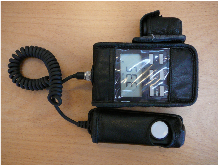
Figur 2.5. Luxmeter til måling af belysningsstyrke
