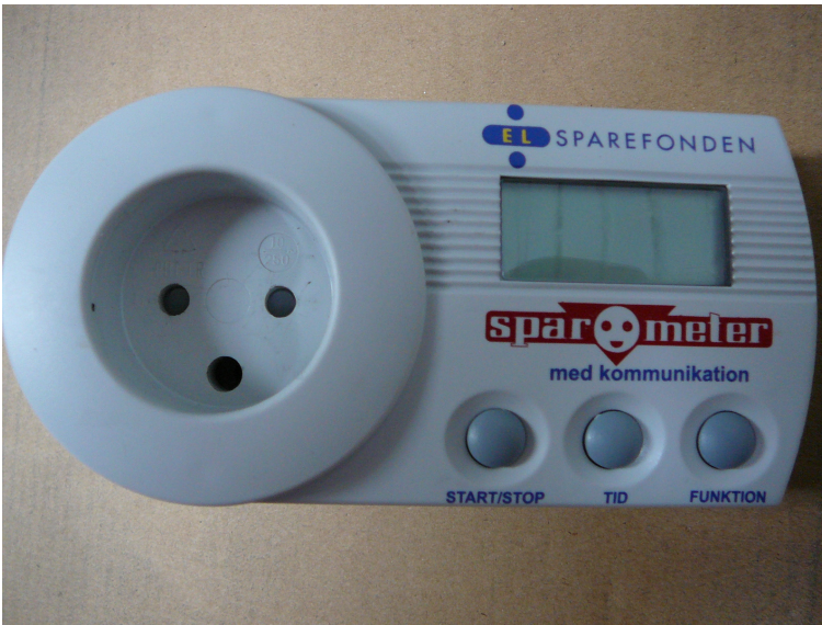
Figur 2.4. Sparometer til måling af effektoptag
