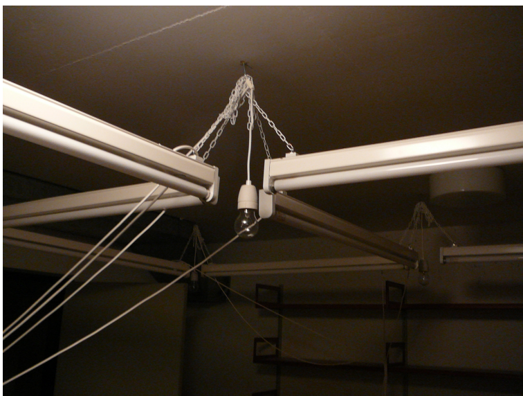
Figur 2.1. Måleopstilling med glødelamper og lysstofrør (med konventionelle og elektroniske forkoblinger)
