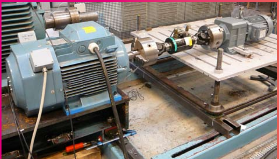
Måleopstilling hos Teknologisk Institut med tandhjulsgearmotor på momentbænk.
