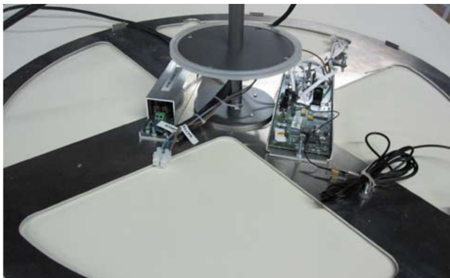
Den elektroniske styring fra NorthSensor monteres i selve mastehovedet
