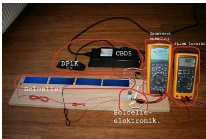
Endeligt design af solcelle-elektronikken ved siden af solceller og LINAK's styrebox CBD5.
