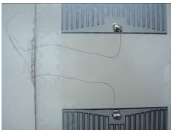
Forsøg med laminering af SunPower cellen, samt forsøg med forskellige tynde metaltråde, som lederbaner.
