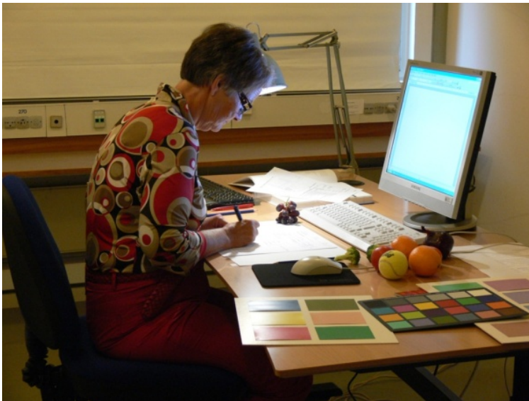
Figur 5.7 Kontor med forsøgsopstilling. En erstatningslyskilde med LED'er er monteret i en standard arkitektlampe. Foto: Steen Traberg-Borup
