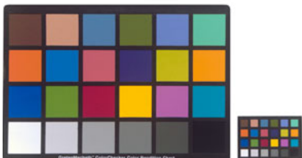
Figur 5.5 Vurdering af farver blev bla. foretaget ved hjælp af ColorChecker-kort fra GretagMacbeth. Foto: GretagMacbeth.
