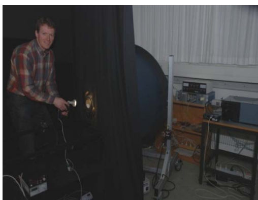
Figur 5.1 Måleopstilling med 1 m integrerende kugle. I fremad flux målingen placeres LED erstatningslyskilden således, at den lyser ind i kuglen igennem portåbningen. Foto: DTU Fotonik
