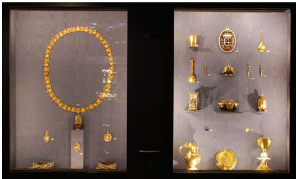
Sammenligning af belysningen i to montres i skatkammerets 1. sektion. Montren til venstre er med pinolglødepære belysning og montren til højre er demonstrationsmontren med det nye LED belysningssystem.
