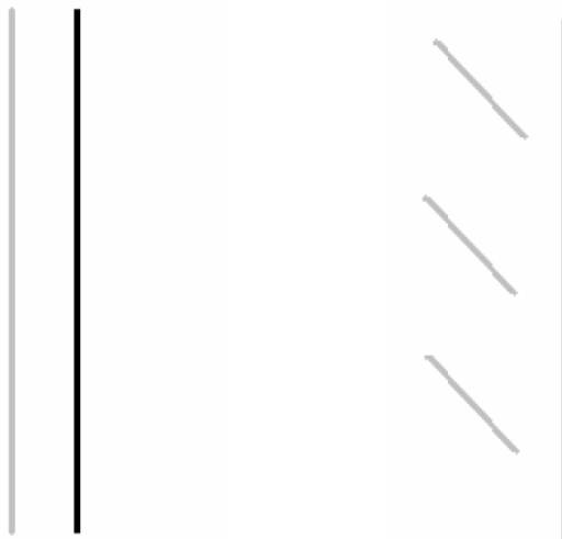
Figur 3. Glaslamellerne i hhv. solafskærmende, tv. og dagslydirigerende position th.
