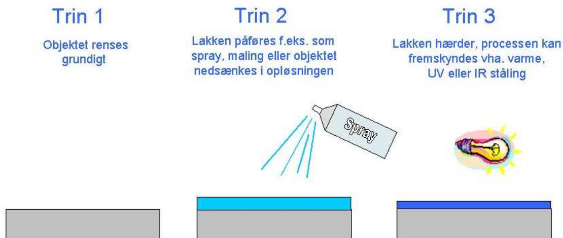
Figur 6-4 Belægningsproces for sol-gel
