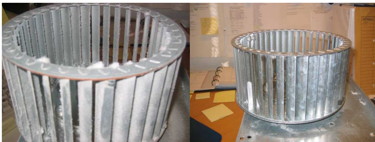
Figur 4-6 Til venstre ses reference blæsehjulet, som overalt er belagt med fnuller, og har et loddent udseende. Til højre ses det sol-gel belagte blæserhjul, som står helt blankt
