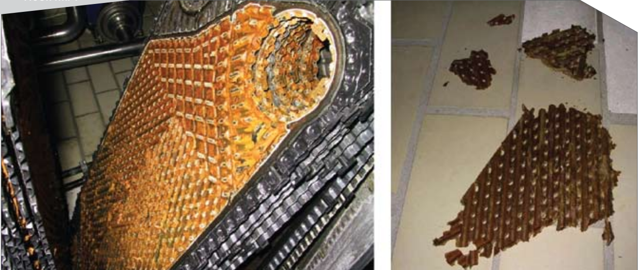
Typisk tilkalkning og tilsmudsning af veksler hos Brabrand Mejeri.
