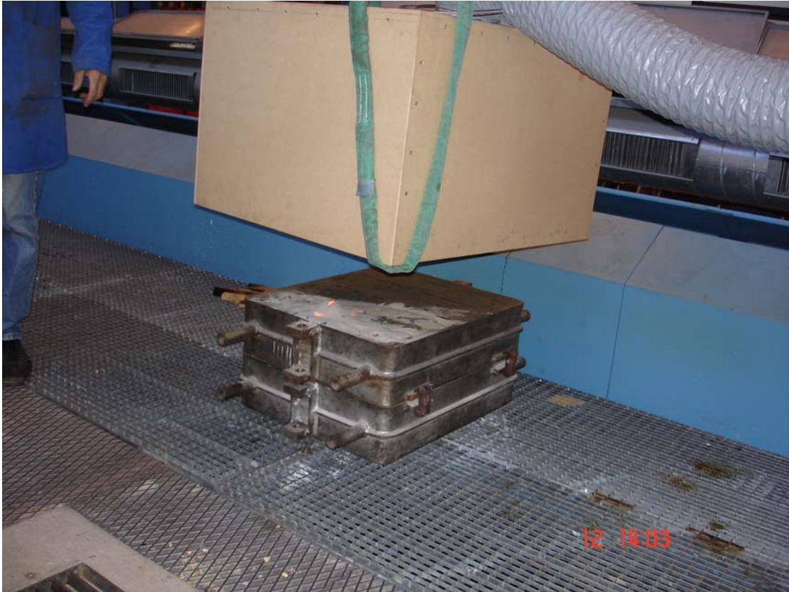
Billede 3.2. Forsøgsopstilling med billede af stor og lille støbeform samt sugenhov
