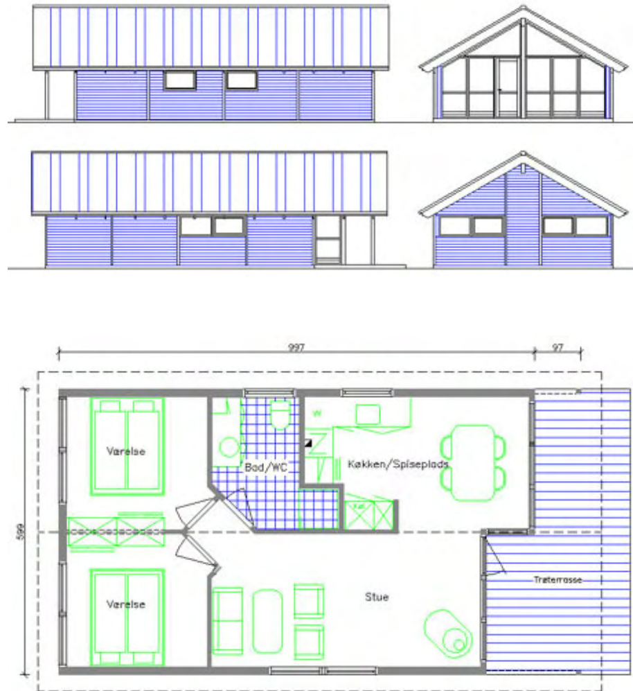
Figur 7. Rømø sommerhuset på 57 m 2 som er anvendt i simuleringerne. Facader og oversigtsplan.
