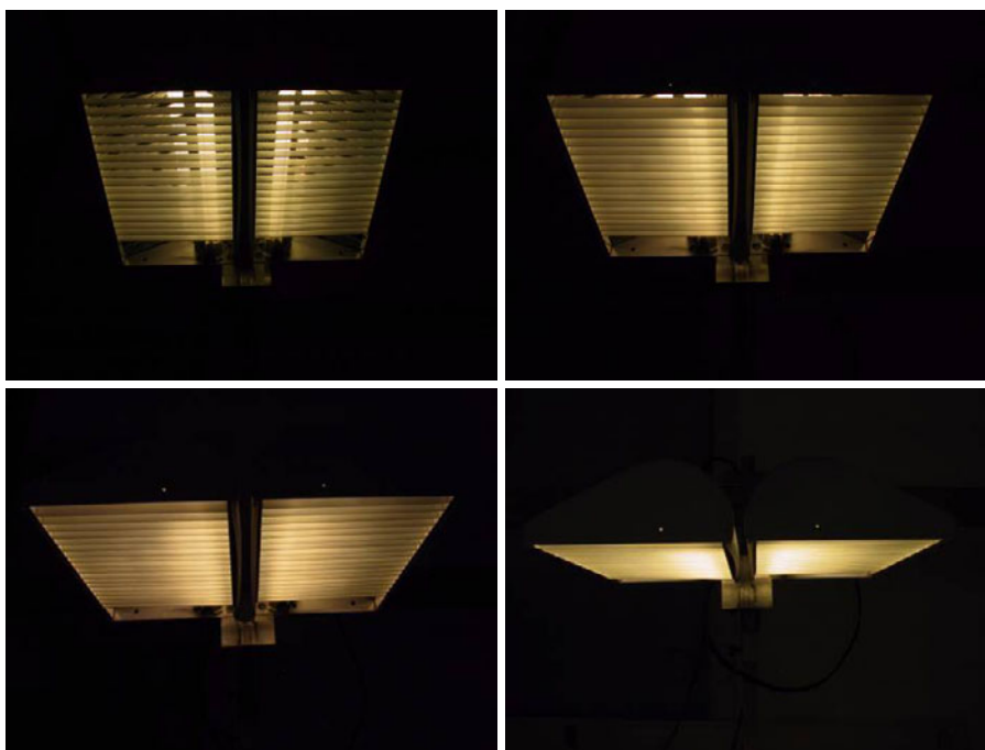
Figur 29. Hvidlakeret metalgitter set nedefra i forskellige vinkler.
