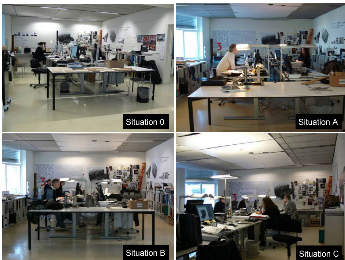
Figur 69. Fotos fra de 4 belysningssituationer, som brugerne blev bedt om at vurdere via spørgeskema. I forhold til den eksisterende situation (0) blev der sat hvide plader på loftet i forsøgssituationerne, idet betydningen af indirekte lys var større her.
