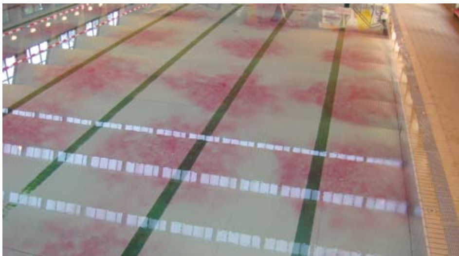
Afsluttende farveprøve i 50 m bassin med hæve-sænkebund. Det ses, hvordan farven breder sig ud fra de nye dyser de første minutter af prøven.
