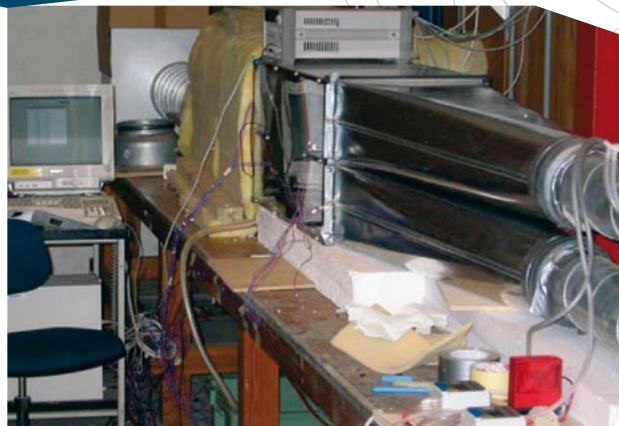
Forsøgsopstilling ved Danmarks Tekniske Universitet til undersøgelse af kondens og isdannelse.
