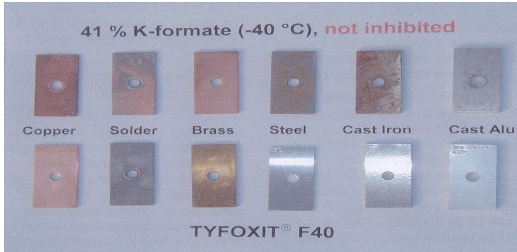
Figur: Visuel sammenligning af metalprøver efter ASTM 1384 test for Tyfoxit F-40 og uinhibiteret kaliumformiat.
