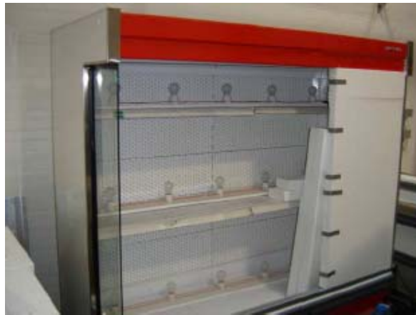
Figur 7.1.4. Reol. Placering af elektrisk belastning. Delvis isoleret.
