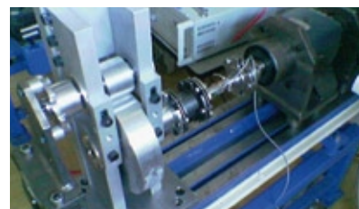
Den ene af de to opbyggede forsøgsmodeller på Institut for Energiteknik er et simpelt magnetgear.
