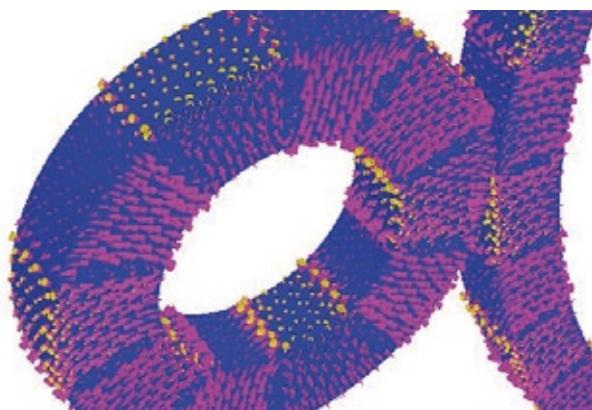
3D finite element beregning af et magnetisk gear.
