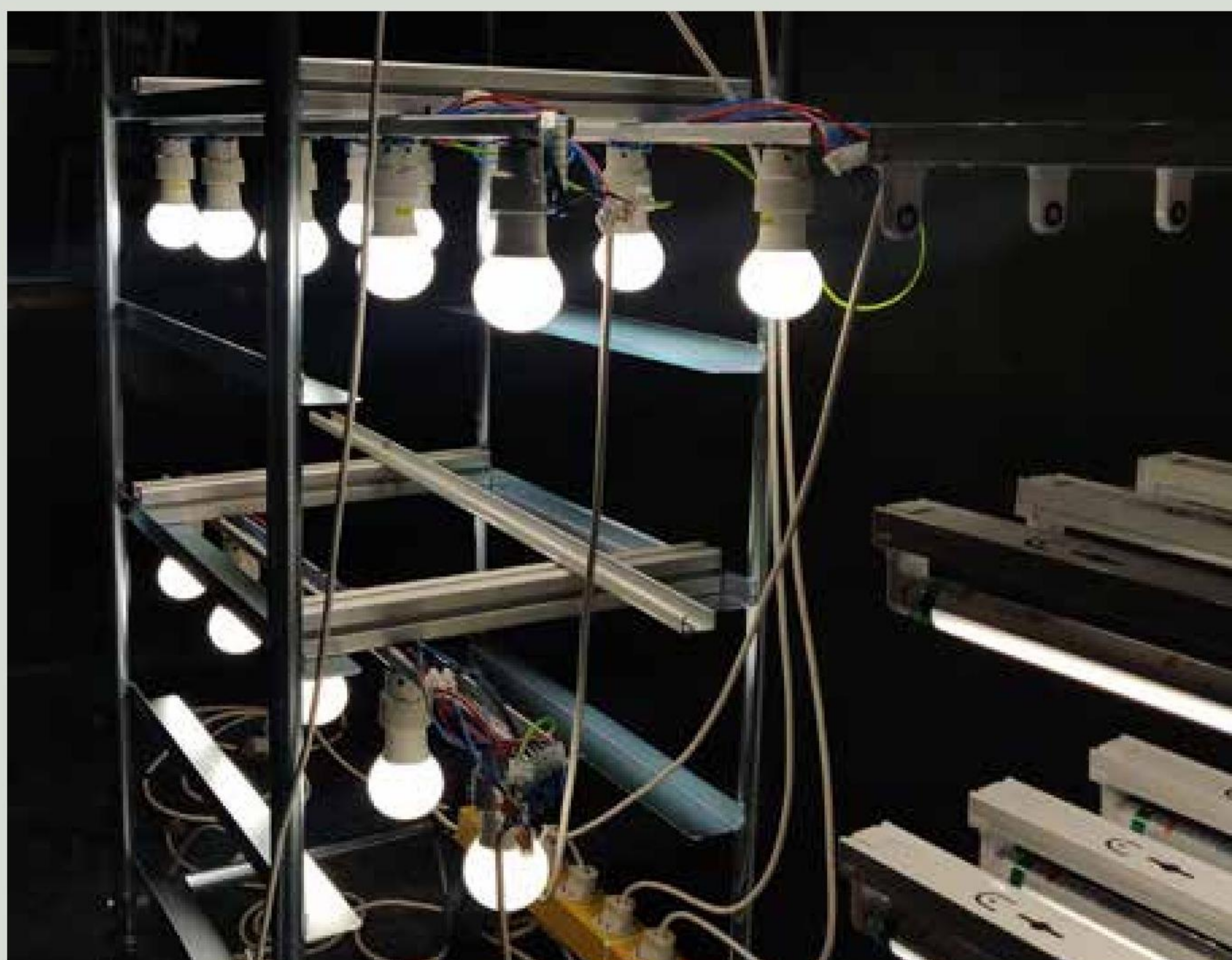
Figur 1: Foto af laborietest af LED-belysningsprodukter, hvor 15 enheder af hver type testes ifølge EU's udholdenhedstest og LM-84. Foto: Carsten Dam-Hansen, DTU Fotonik.
