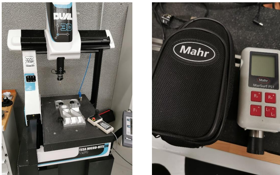
Figur 11: Venstre, TESA CMM-opmåler. Højre, Mahr ruhedsmåler
