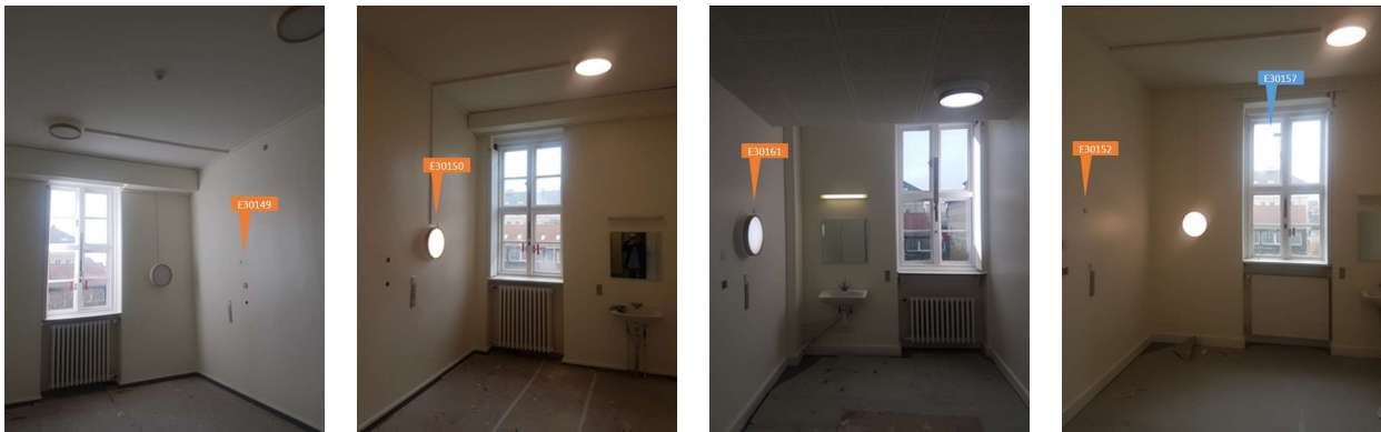
Figur 3 Placering af sensorer på de SV vendte stuer, fra venstre stue 6, 7, 8 og 9.
