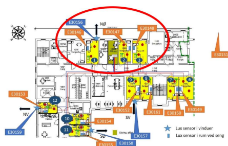
Figur 7 Målt vertikal illuminans i NØ vendte stuer, ved sengen i stue 1 (rød kurve), ved sengen i stue 2 (grøn kurve), ved sengen i stue 3 (blå kurve) og ved vinduet i stue 1 (sort kurve), som funktion af tid over et døgn den 1-4-2019. Til højre ses oversigt med rød ring markering af de stuer måling er vist for.
