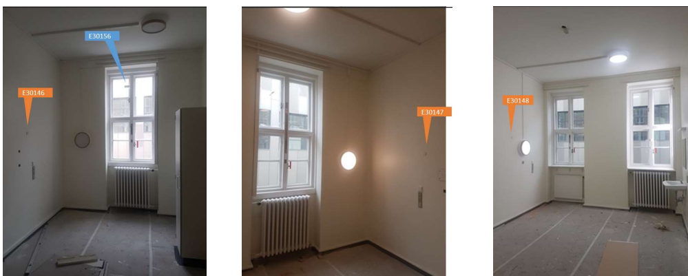
Figur 2 Placering af sensorer på de NØ vendte stuer, fra venstre stue 1, 2 og 3.
