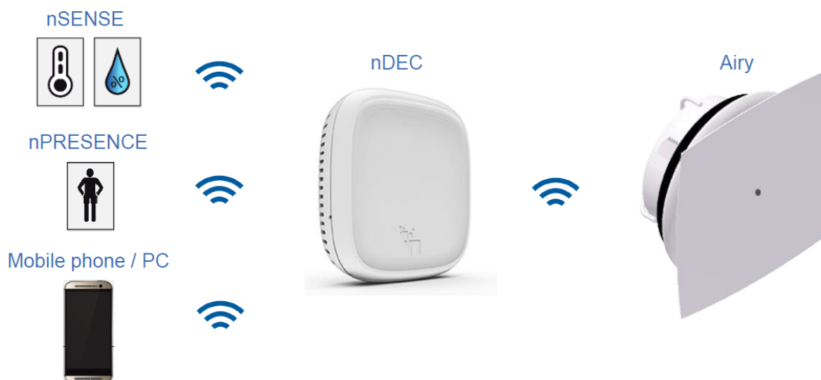
Figur 13: Kommunikation fra sensorer til n_dec og ventil (Airy)
