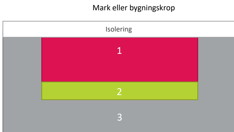
Figur 1 Snittegning af et ASES varmelager
