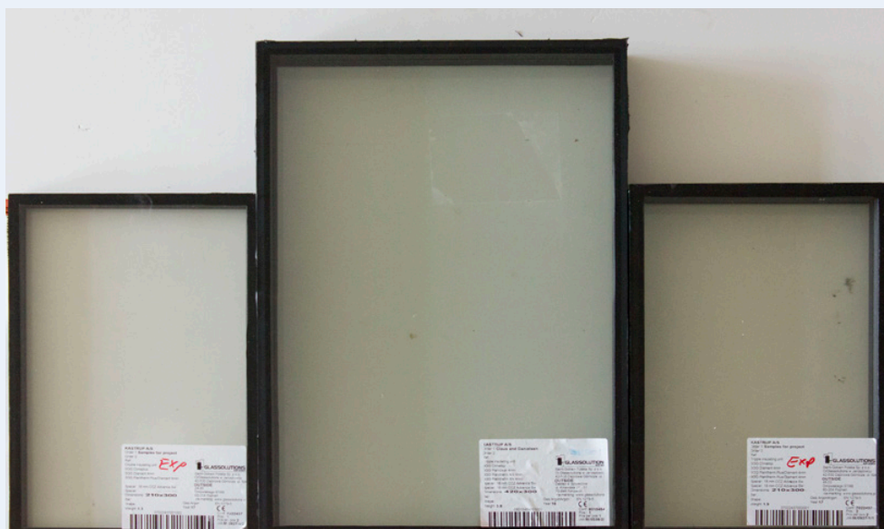
Fig 3. Rudetyper. 2-lags energirude med jernfattigt glas (tv) og 3-lags standard energirude (th) I midten 3-lags energirude med jernfattigt glas som supplerende reference i laboriemålinger
