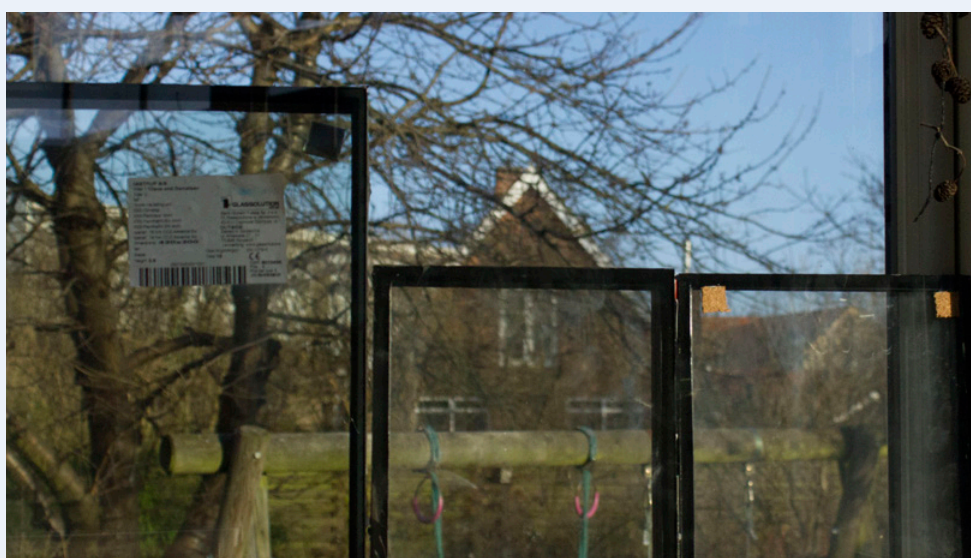
Fig 4. Rudetyper. 2-lags energirude med jernfattigt glas (th) og 3-lags standard energirude i midten. 3-lags energirude med jernfattigt glas som supplerende reference i laboriemålinger (tv)
