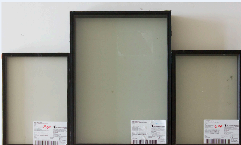
Fig 2. Rudetyper. 2-lags energirude med jernfattigt glas (tv) og 3-lags standard energirude (th) I midten 3-lags energirude med jernfattigt glas som supplerende reference i laboratiormålinger
