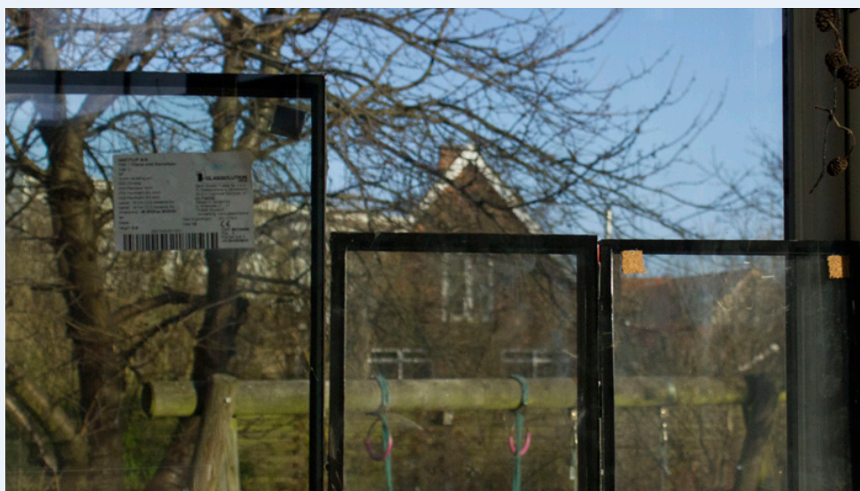
Fig 3. Rudetyper. 2-lags energirude med jernfattigt glas (th) og 3-lags standard energirude i midten. 3-lags energirude med jernfattigt glas som supplerende reference i laboratiormålinger (tv)
