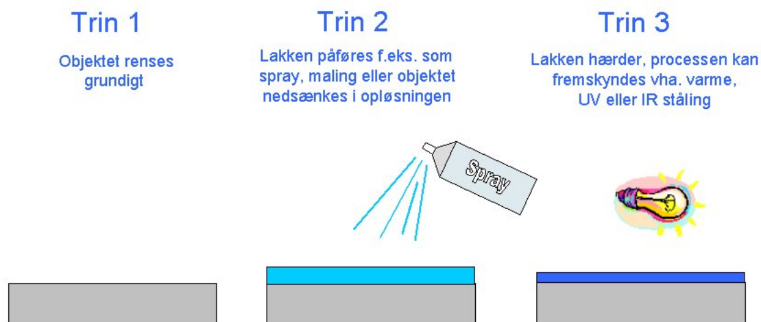
Figur 3: Belægningsproces for sol-gel
