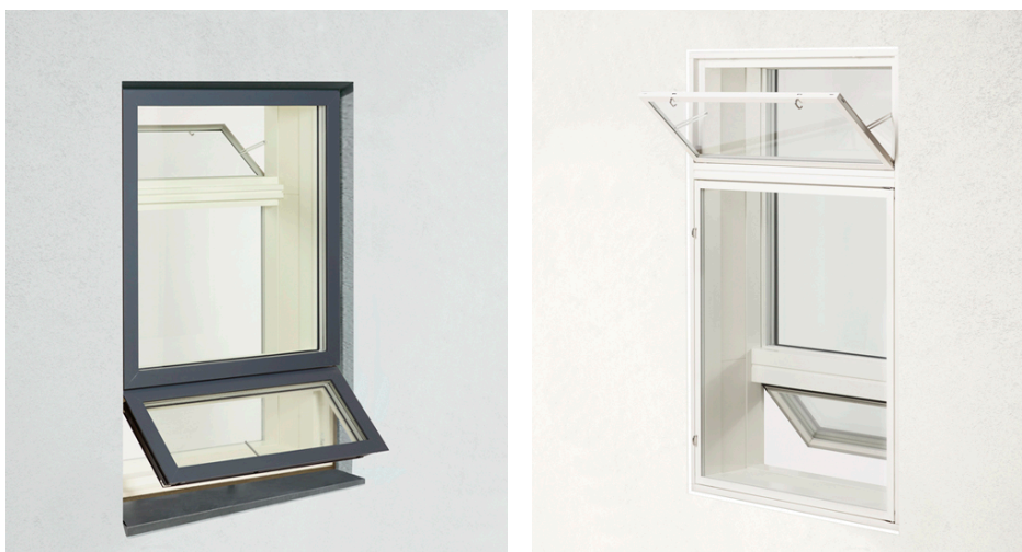
Figur 39. Eksempel på variant af det såkaldte 'russer-vindue', her udviklet af Velfac. Luften tages ind gennem en lyd-dæmpet åbning og forvarmes, inden den strømmer ind i rummet. Foto/rendering: Velfac.
